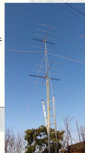
FM受信用 ダイバシティ アンテナの例
